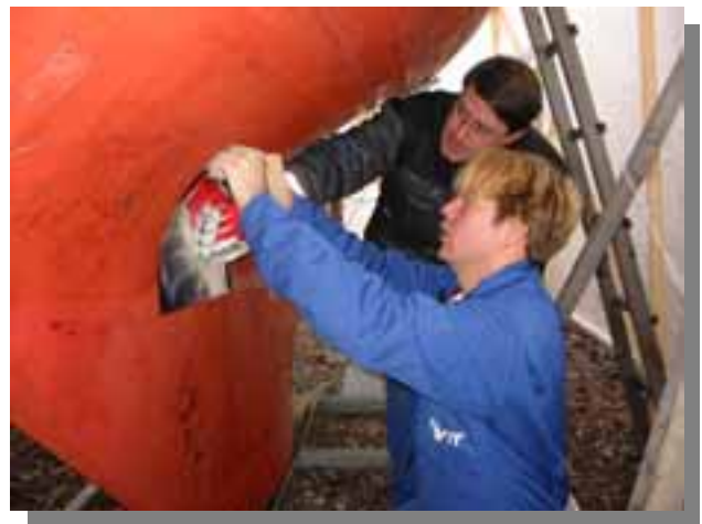
Marko ja Kari asemoimassa röntgenfilmiä
